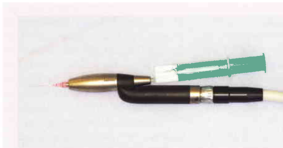
Das RinsEndo-Handstück wird auf die Turbinenkupplung aufgesetzt. Aus der aufgesteckten Einmalspritze wird Natriumhypochlorit angesaugt und über die spezielle Kanüle in den Wurzelkanal befördert. In der Saugphase werden verbrauchte Lösung und Luft zurück gesaugt (Abb. 3).
